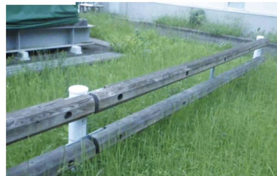
木製ガードレールビームとして (研)森林総合研究所構内にて屋外暴露実施中
